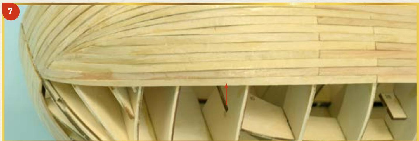
**7** Приклейте следующую планку к носовой части каркаса, предварительно обрезав и заузив ее так, как показано на фотографии.
