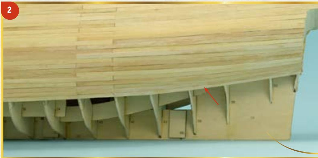
**2** Завершите неоконченный ряд планок обшивки, работу над которым вы начали в выпуске 42. Для этого приклейте планку к кормовой части каркаса. Помните, что планки всегда нужно обрабатывать в соответствии с формой вашей модели.
